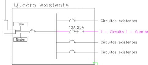
Instalar disjuntor monopolar e IDR bipolar p/ circuito da guarita
