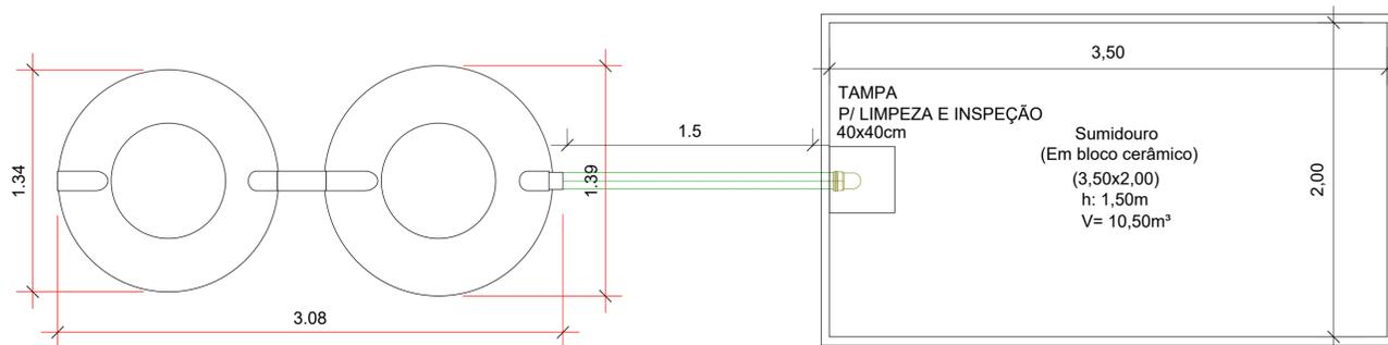
**PLANTA BAIXA-SISTEMA DE TRATAMENTO DE ESGOTO**
