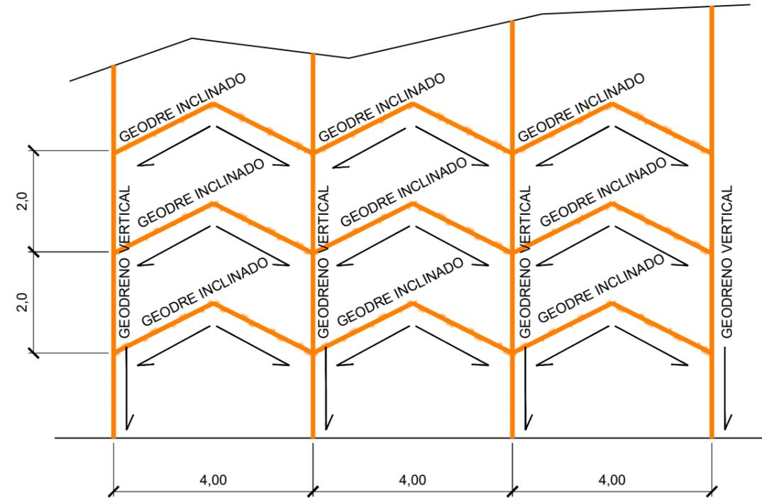
VISTA FRONTAL TÍPICA DOS DRENOS DE SUPERFÍCIE
