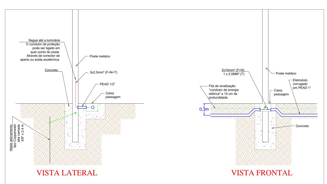
DETALHE DA IMPLANTAÇÃO DA CAIXA DE PASSAGEM E FIAÇÃO
