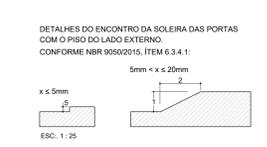
A INCLINAÇÃO TRANSVERSAL DA SUPERFÍCIE DEVE SER DE ATÉ 2% PARA PISOS INTERNOS E ATÉ 3% PARA PISOS EXTERNOS. A INCLINAÇÃO LONGITUDINAL DA SUPERFÍCIE DEVE SER INFERIOR 5%. CONFORME NBR 9050/2015, ITEM 6.3.3
