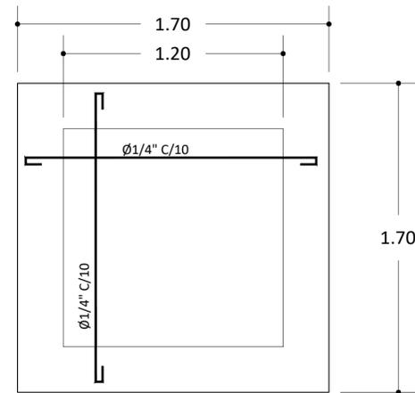
**LAJE CONCRETO ARMADO**
